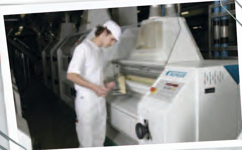
Les blutoirs horizontaux, qui fonctionnent en principe comme de simples tamis, permettent de trier les produits moulus selon leur grosseur. Un blutoir horizontal remplace un grand nombre de cribles, car on peut y superposer plusieurs tamis dont les mailles sont de différentes largeurs. Cela permet de trier les produits moulus en semoules grossières et fines, en finots et en farine.
